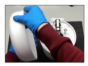
• Svitare le 4 viti e rimuovere il piano pompa lentamente.
