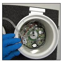
• Rimontare lo strumento, alimentare e vedere il protocollo nel par. 2.5 per configurare il modem.
