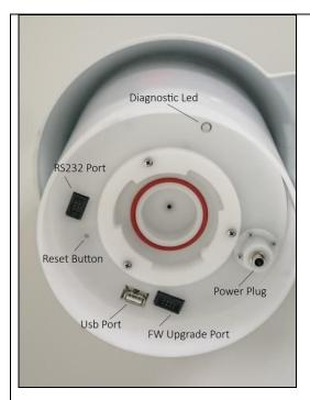
Corpo del campionatore, contiene la scheda processore il modem e la pompa. Alloggia tutte le porte di comunicazione.
