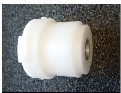
• L'impattore accumula la polvere che non deve raggiungere il filtro, pulire la superficie dell'impattore e ricoprirla con un sottile stratto di grasso siliconico per meglio trattenerla.
