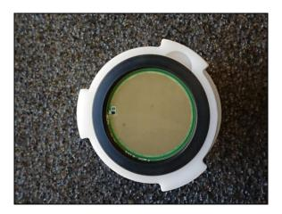
• Inserire la testa di prelievo nell'apposita sede e avvitare a fine corsa.
