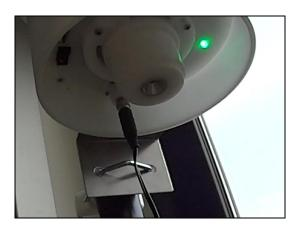
• Per rimuovere la testa di prelievo, assicurarsi che il ciclo di campionamento sia terminato (led blu lampeggiante). Svitare la testa di prelievo ed estrarla, poi sollevare il bordo del portafiltro agendo sull'apposito spazio per l'unghia. Lo stato torna automaticamente in READY (led blu fisso).
